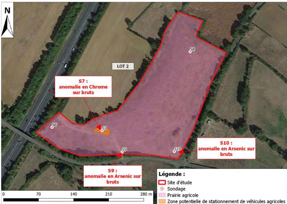
Figure 27 : Carte récapitulative des anomalies mesurées dans les sondages – Lot 2 (Source : Google satellite 2018 ; Réalisation : CERAG)
