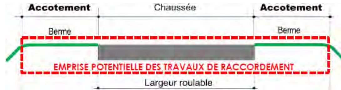
Figure 70. Schéma de l'emprise des travaux de raccordement
